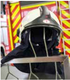
Feuerwehrleute tragen im Einsatz spezielle Helme. Unter dem schwarzen Schild lässt sich eine Scheibe herausziehen, die das Gesicht schützt. Hinten am Helm verhindert ein besonderes Tuch, dass Flammen oder brennende Teile an den Hals gelangen.
